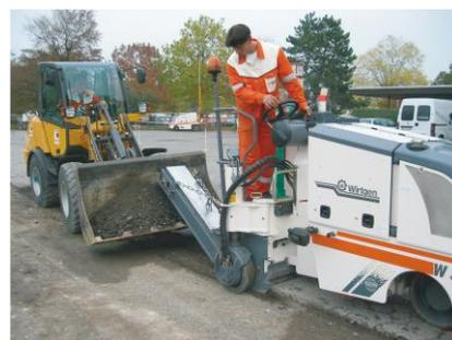
FRAISEUSE A FROID AVEC CONVOYEUR
