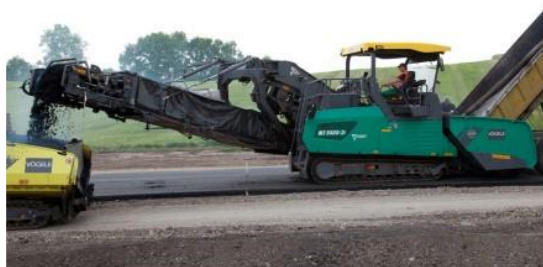
ENGIN D'ALIMENTATION POUR FINISSEUSE
