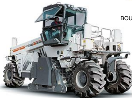
ENGIN STABILISATION TERRAIN
